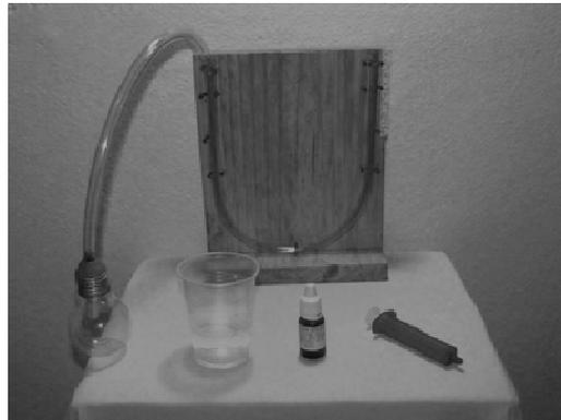
Imagem 1: Montagem do termoscópio junto aos outros materiais utilizados
