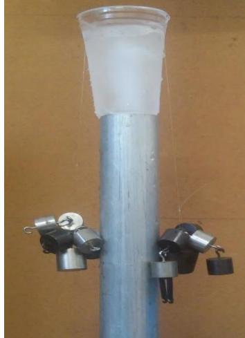
Figura 2: Montagem experimental do estudo sobre regelo.
