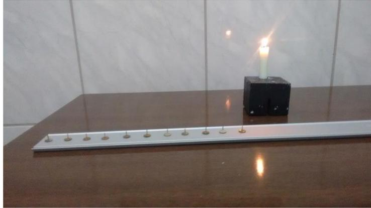
**Figura 9** - Tachinhas fixadas com parafina a haste metálica.
