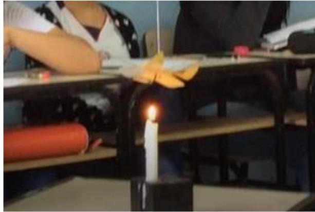
**Figura 8:** Progação de calor por convecção (cata-vento).
