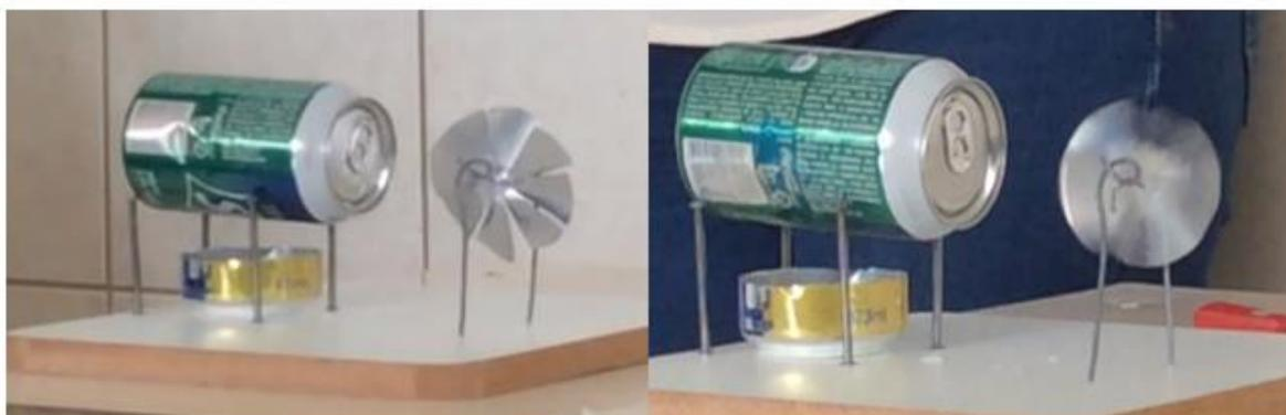
**Figura 14:** Máquina térmica construída com materiais de baixo custo.
