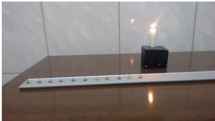
**Figura 3:** Tachinhas fixadas com parafina a haste metálica.
