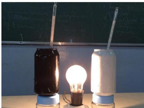
**Figura 9:** Demonstração de propagação de calor por radiação.
