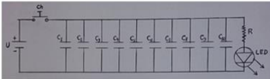
Figura 4.7 – Esquema representativo do circuito elétrico (RC) do aparato experimental montado para a aula com demonstração na 3ª série do ensino médio.
